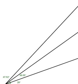
Figura 4. Ejemplo de que al doble o triple de la proyección en la vertical, no le corresponde el doble o triple del ángulo.
